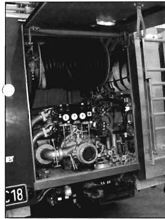
Pumpe mit 60 m Hochdruckschlauch auf Haspel
