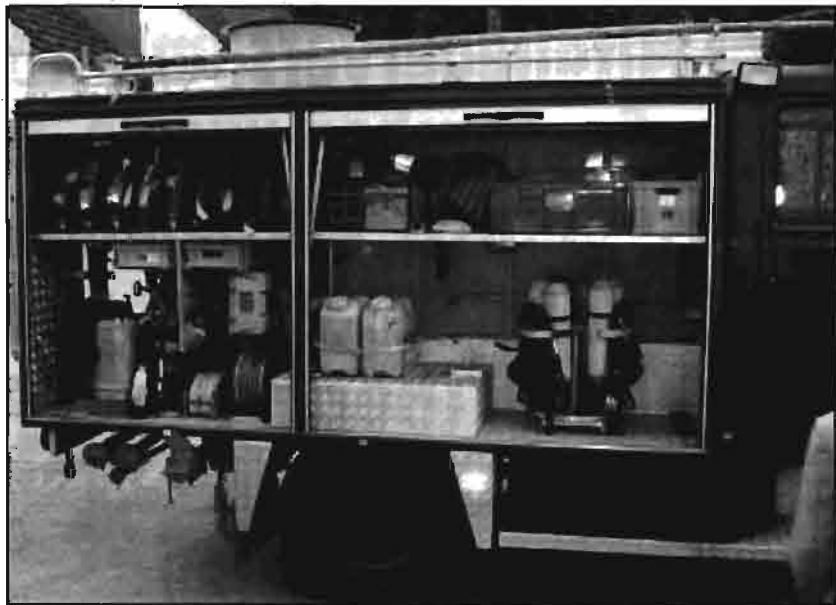
Seitenansicht mit Unterwasserpumpe, div. Schläuchen und Atemschutzgeräten
