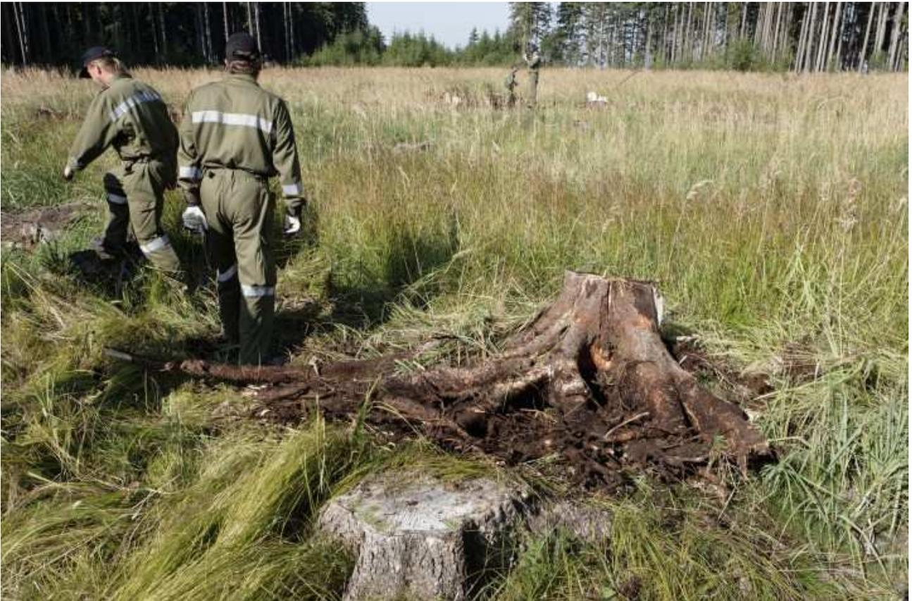
Bei der dritten Serie gelang eine Bilderbuchsprengung, der Wurzelstock wurde in 5 Teile gerissen und lag ringförmig im Umkreis von 2 Metern um den Sprengkrater.
