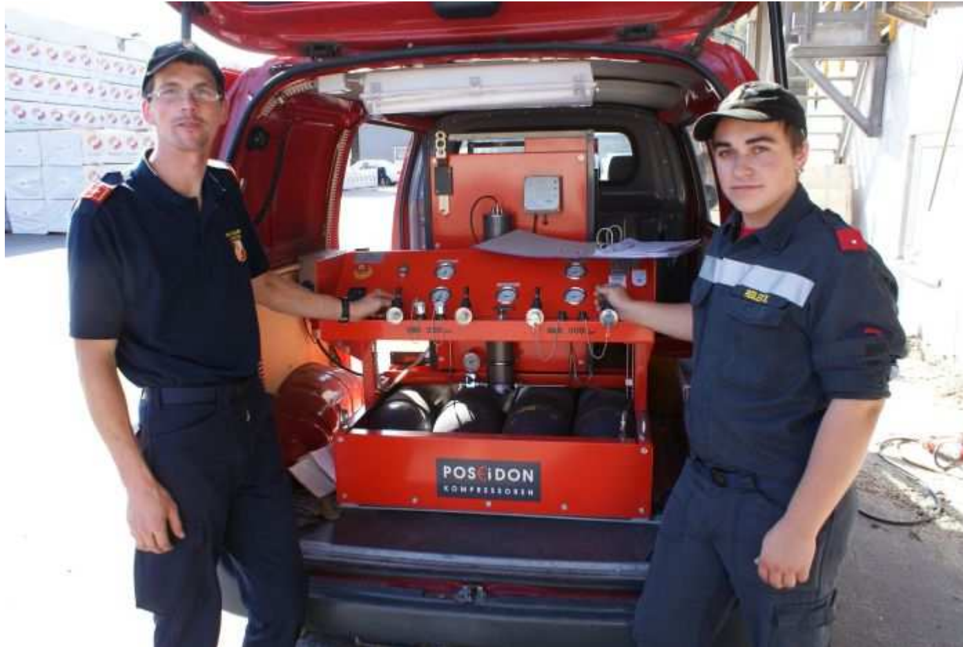
Befüllungsstation beim Atemluftkompressorfahrzeug
