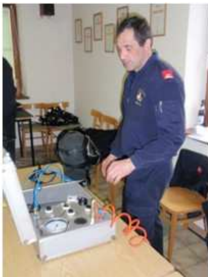
Die Masken werden auf einem Prüfkopf angelegt und so auf Dichtheit kontrolliert, hier von OLM Martin Wagner und OBI Manfred Häusler.
