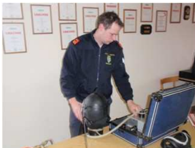
Die Masken werden auf einem Prüfkopf angelegt und so auf Dichtheit kontrolliert, hier von OLM Martin Wagner und OBI Manfred Häusler.
