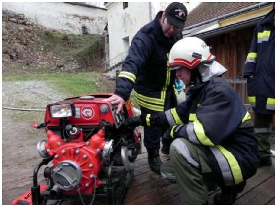
Noch schnell TS entleeren und die Dichtheitsprobe,...
