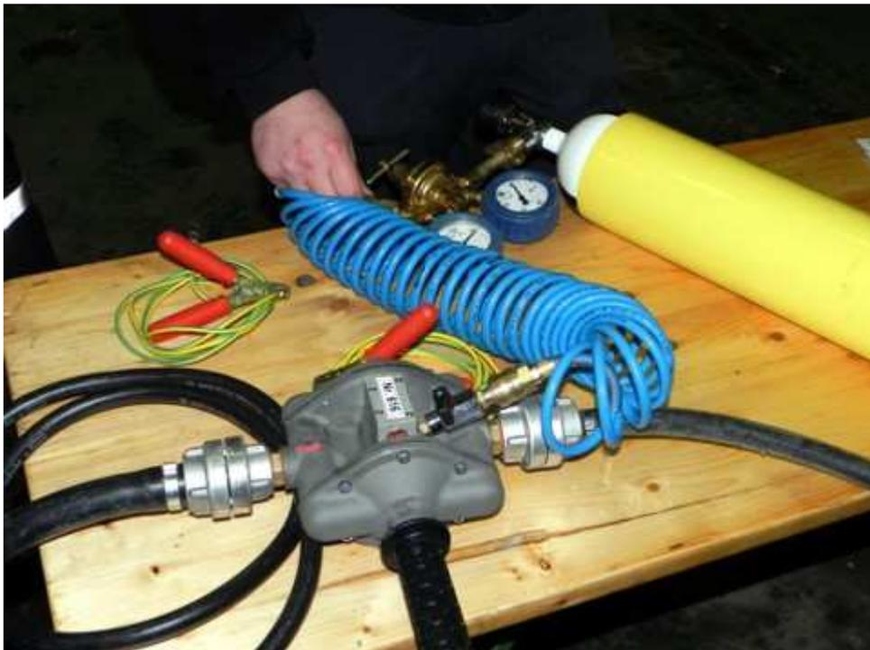
...die einfach mit Druckluft funktioniert und kleinere Mengen problemlos umpumpt
