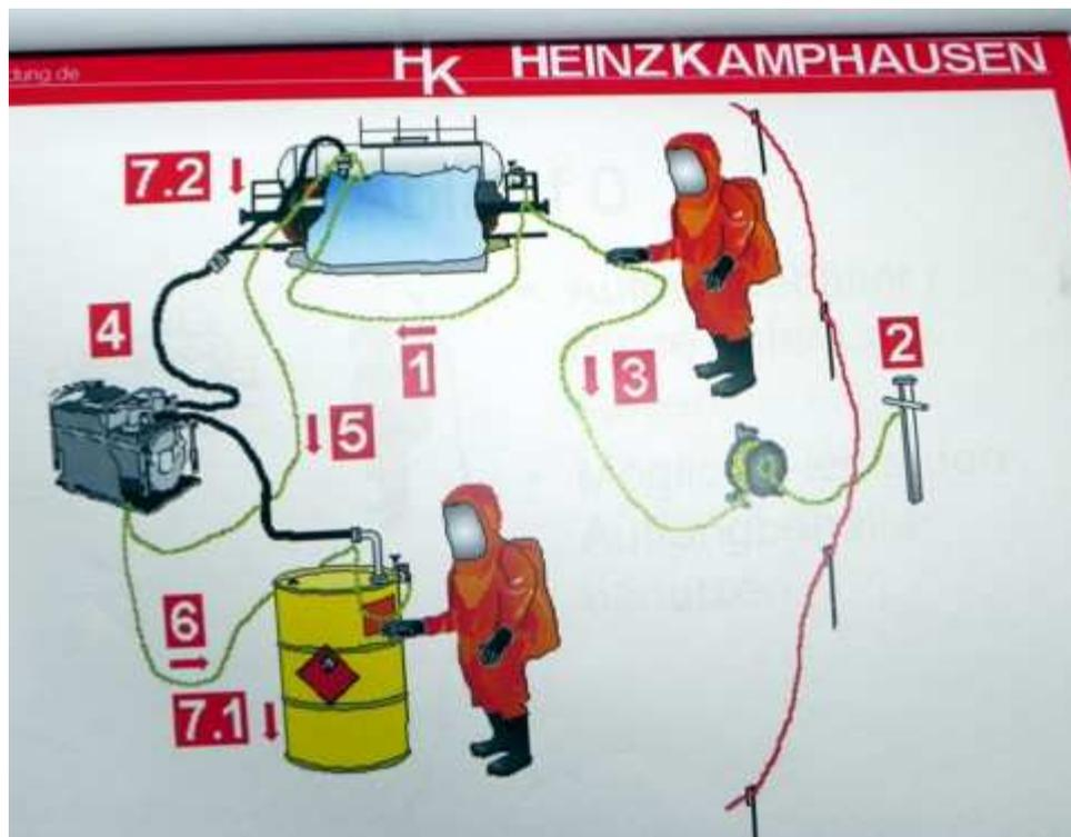
schematischer Aufbau samt Erdung
