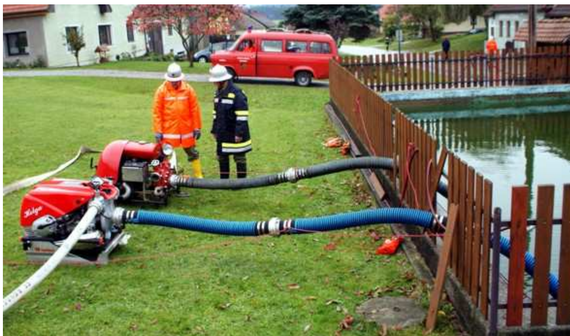
Wasserversorgung mit 2 Tragkraftspritzen
