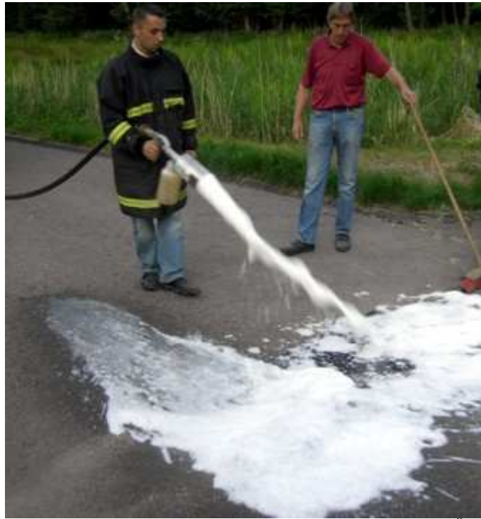
Aufbringung des Bioversals mit der Schaumpistole auf einen Ölfleck
