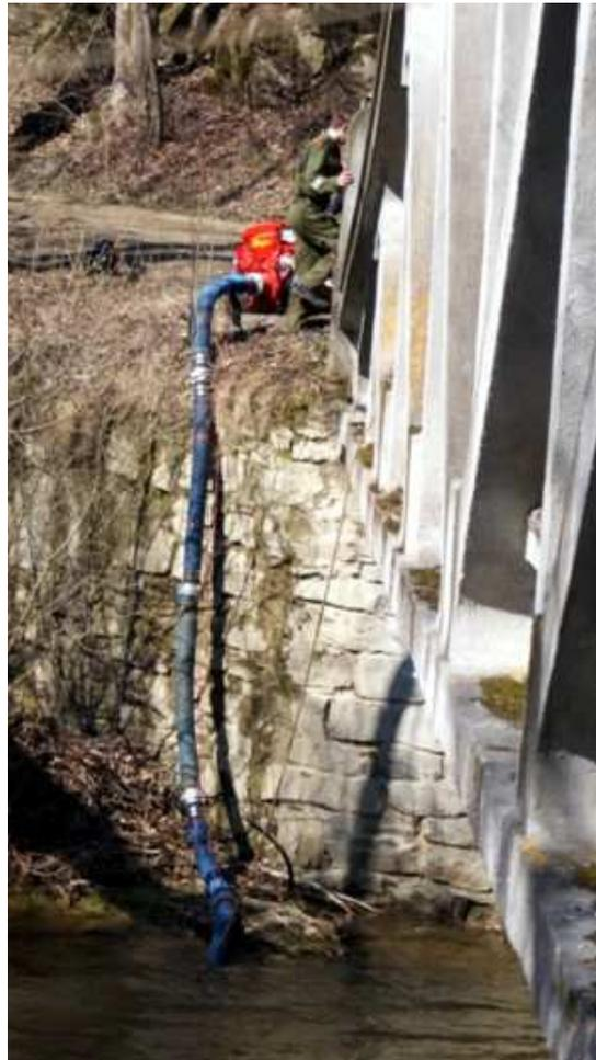
Die Löschleitung beginnt bei der Kammertorbrücke mit einer TS
