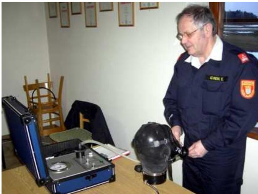
Die Masken werden auf einem Prüfkopf angelegt und so auf Dichtheit kontrolliert, hier von HBM Emmerich Schrenk
