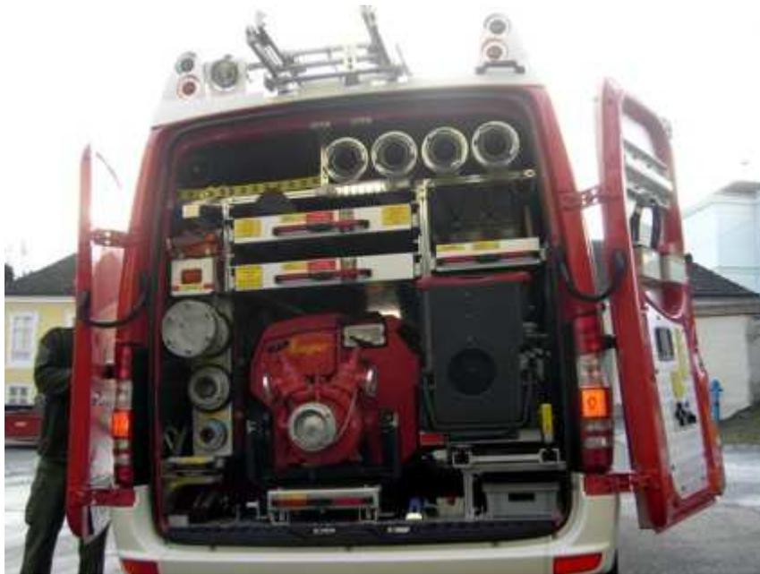
Im Heck ist neben der Tragkraftspritze (Mitte) der Stromerzeuger (rechts) sowie die wasserführenden Armaturen, Werkzeug etc. verstaut.
