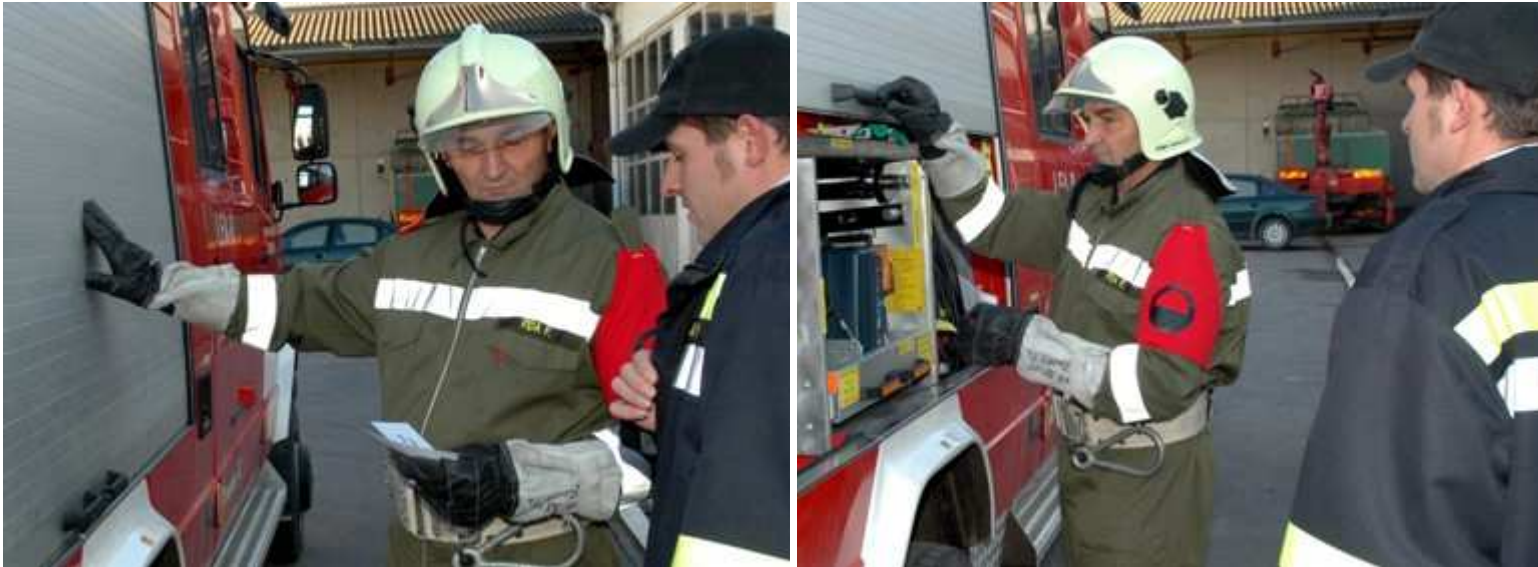
Zu Beginn jeden Durchganges steht die Gerätekunde: bei geschlossenem Fahrzeug ist die Lage von jeweils zwei Geräten zu zeigen - Kontrolle durch den Prüfer
