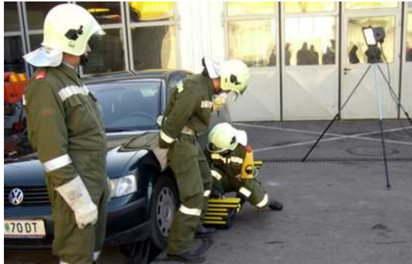
Sichern des Fahrzeuges durch Unterschiebblöcke und Radkeile
