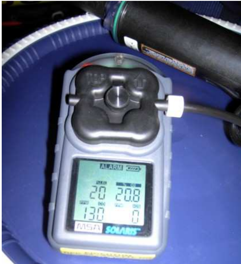
Im Testeinsatz mit einem Gemisch aus Isopropylalkohol und Wasser
