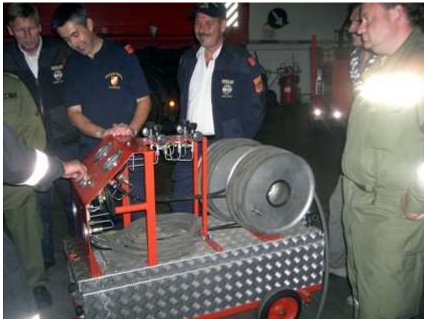
2 gefüllte Speicherflaschen sollen im Einsatzfall die Fremdluftversorgung für 2 Trupps ermöglichen
