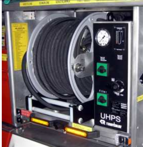
Neben der Ausrüstung für Brandeinsätze wie Atemschutz und Höchstdrucklöschanlage...
