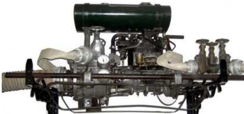
Die heute noch vorhandene Tragkraftspritze aus dem Baujahr 1942 (natürlich nicht mehr im Einsatz, aber noch funktionsfähig)
