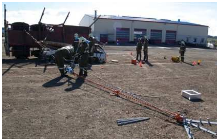
Mit dem Greifzug erfolgt die Gegensicherung des Anhängers beim Aufstellen mit der Seilwinde des RLF
