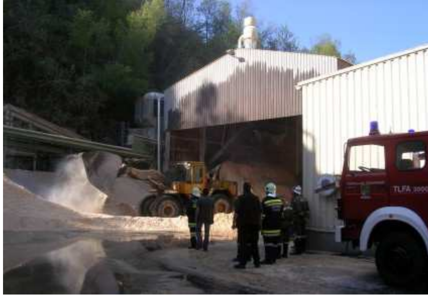
Ausräumen der durch die Sprinkleranlage größtenteils abgelöschten Hobelspane
