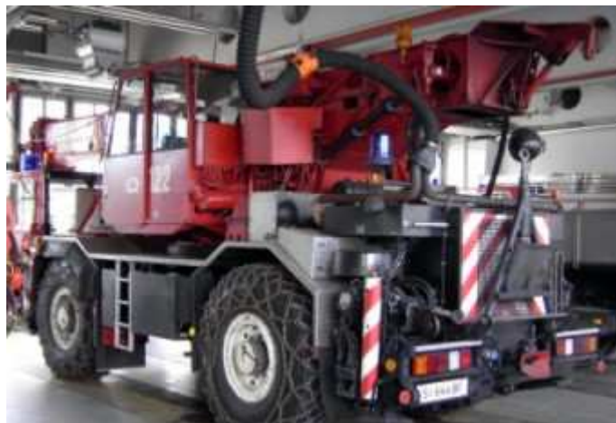
Kranfahrzeug mit 20t-Kran
