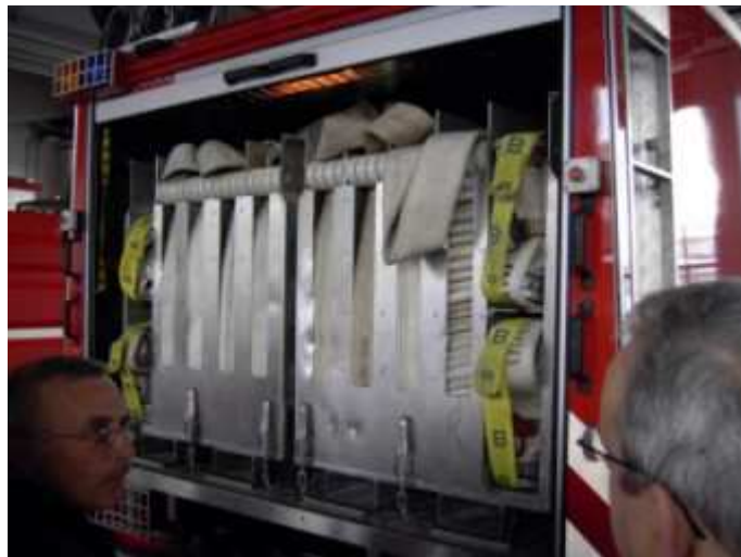
Das Schlauchfahrzeug mit vorgekuppelten B-Schläuchen im Container-System
