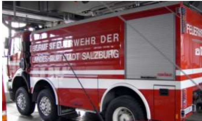
Tank 3 Maxglan (Großtanköschfahrzeug mit 2 Vorderachsen bewährt sich bestens, weil das Fahrzeug besser lenkbar ist)
