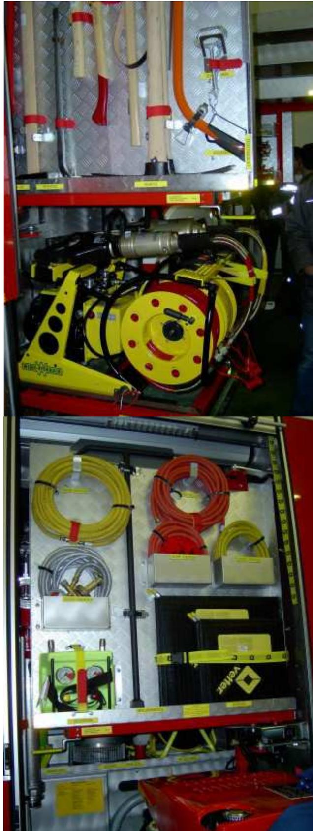
hydraulisches Rettungsgerät sowie Hebekissen...
