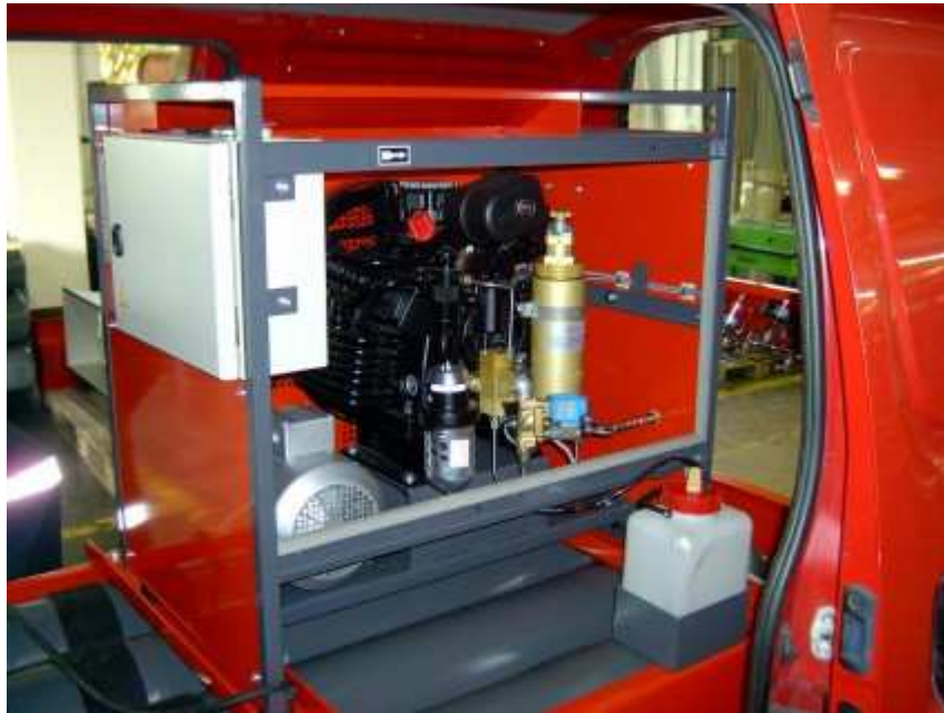
Der Kompressor wird mit einem 5,5 kW-Elektromotor angetrieben, rechts die Kondensatautomatik mit Stillstandsentswässerung, über dem Motor die elektrische Steuerung
