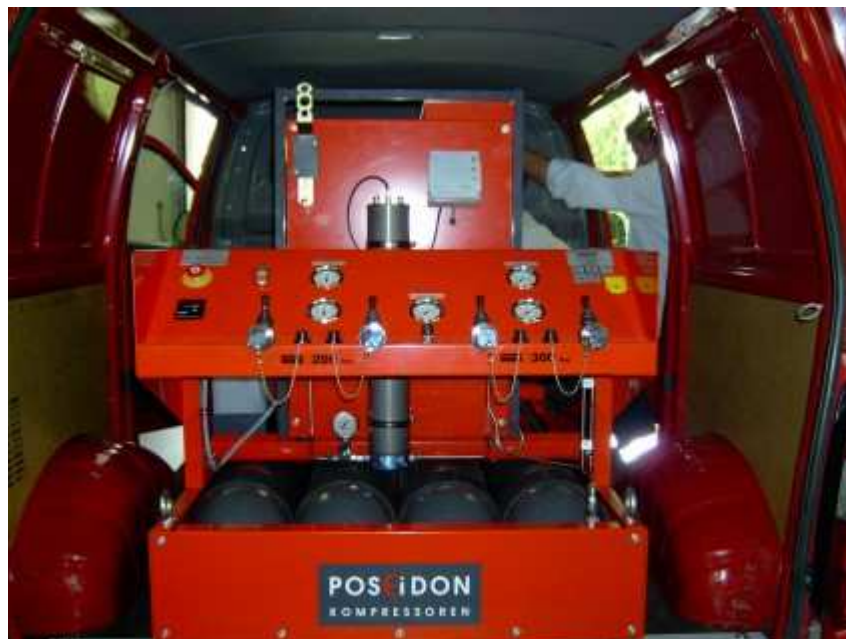
Blick von hinten in das ALF: Füllrampe für je 2 Flaschen zu 200 bar und 300 bar, darunter 4 Atemluftspeicherflaschen à 50 Liter für max. 350 bar Betriebsdruck, dahinter befindet sich der Atemluftkompressor PFU 250 E (Luftlieferleistung 250 l/min, Betriebsdruck 330 bar)
