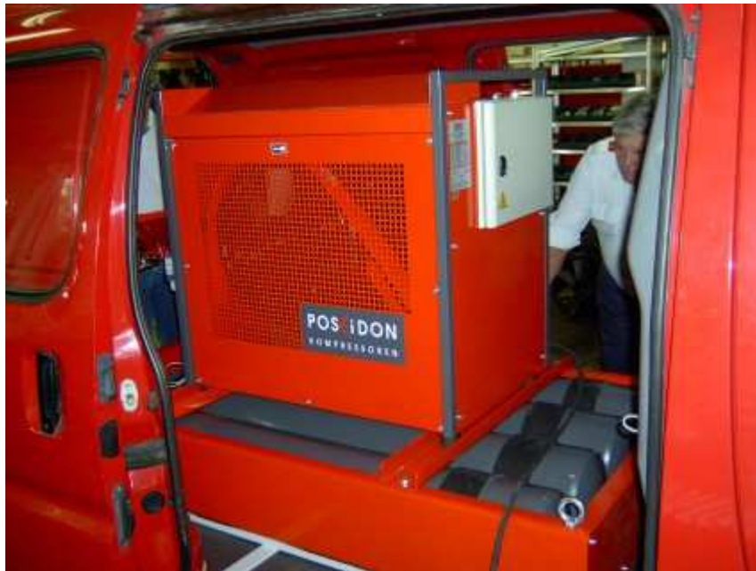
Der Kompressor wird mit einem 5,5 kW-Elektromotor angetrieben, rechts die Kondensatautomatik mit Stillstandsentswässerung, über dem Motor die elektrische Steuerung
