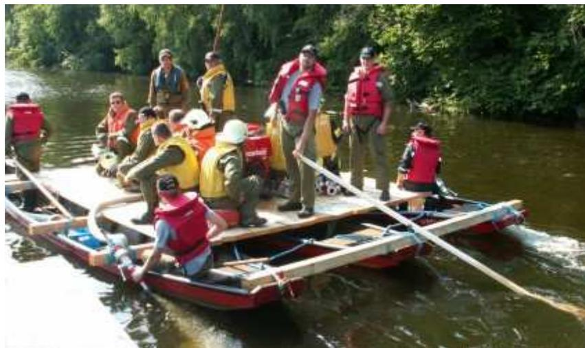
Angetrieben wird dieses durch eine Tragkraftspritze und den Rückstoß aus zwei Strahlrohren
