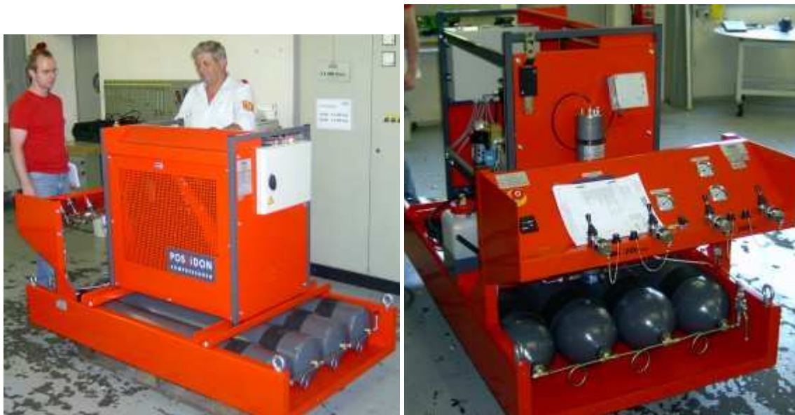
EBI Bachtrog inspiziert die zum Einbau fertige Kompressoranlage
