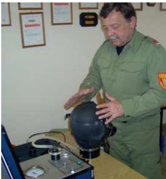
Wichtig ist auch die Dichtheit der Atemschutzmasken wird mit einem Prüfkoffer und aufblasbarem Prüfkopf. Kleinere Reparaturen wie Austausch von Membranen direkt vor Ort vorgenommen werden.
