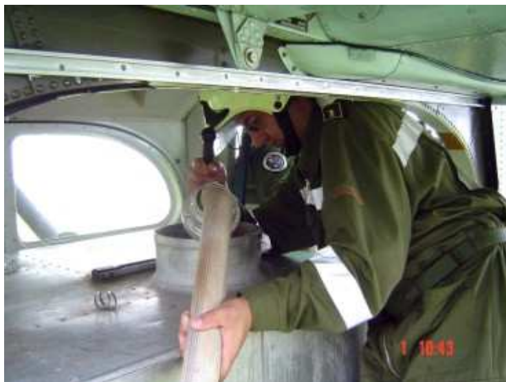
Das Befüllen des Löscheinbehälters
