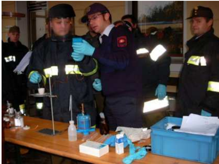
chemische Versuche zur Bestimmung eines unbekanntes Stoffes mit dem Chemiekoffer
