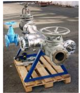
Übungsverteiler für Schadstoffübungen
