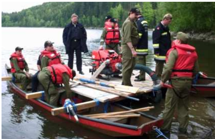
Zur Fortbewegung diente eine normale Tragkraftspritze, die das Wasser ansaugte und über 2 B-Strahlrohre den nötigen Rückstoß erzeugte
